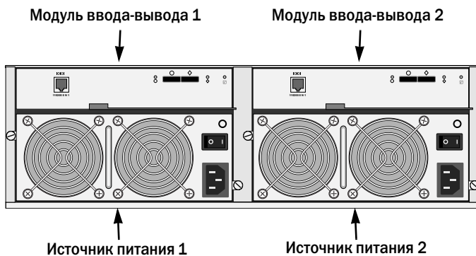
Рис. 2. Вид устройства VTrak J630s сзади. Модель J830s выглядит аналогично
