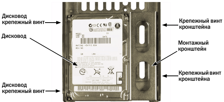
Рис. 10. Расположение монтажных винтов на держателе дисковода
