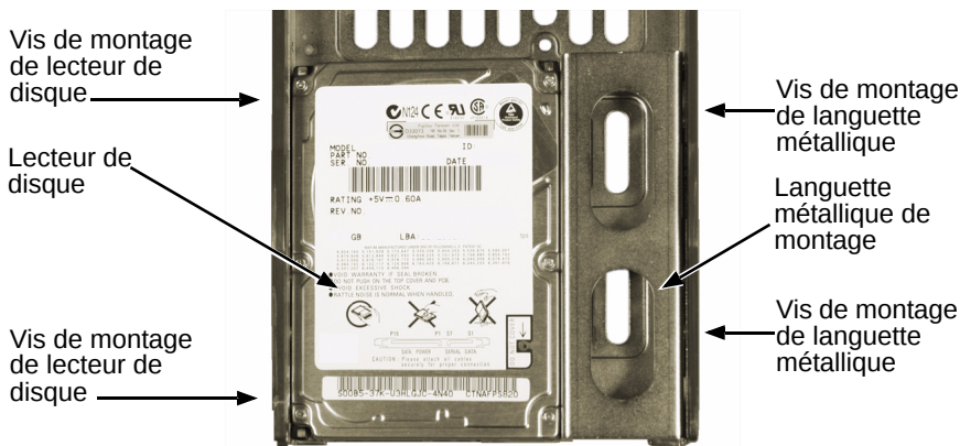
Figure 10. Emplacements des vis de montage du support de lecteur
