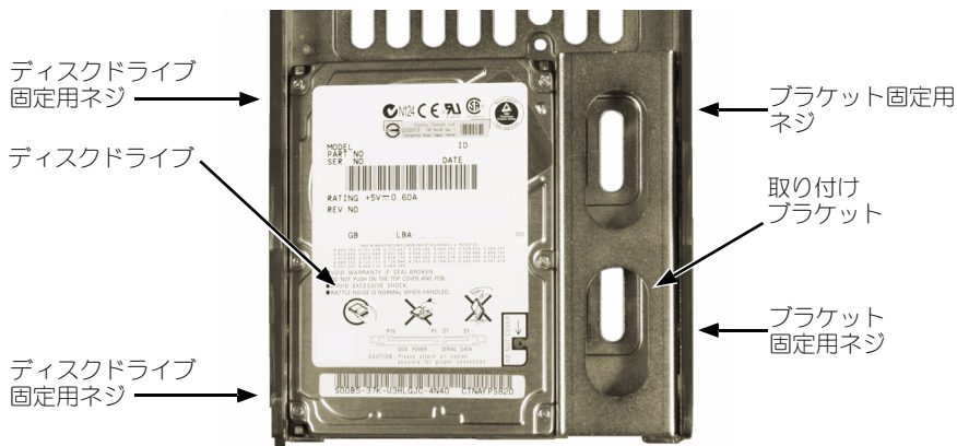
図 10. ドライブキャリア固定用ネジの位置
