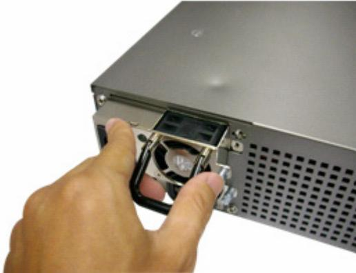
5. Befestigen Sie die Schraube am Netzteil durch Drehen im Uhrzeigersinn.
