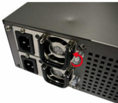
3. Trennen Sie das defekte Netzteil.
